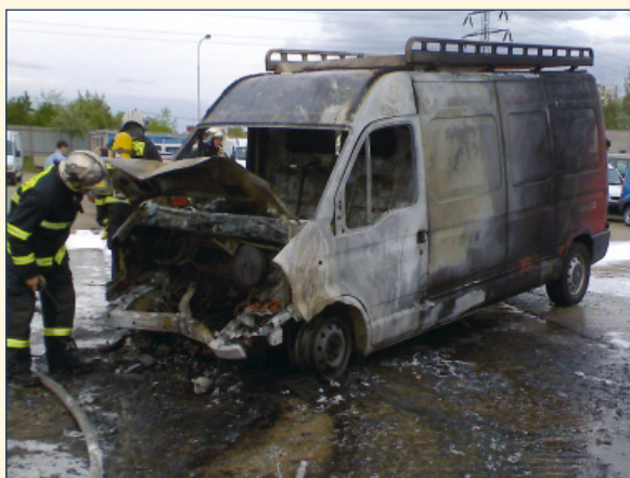
Renault servis - neodpojené akumulátory
